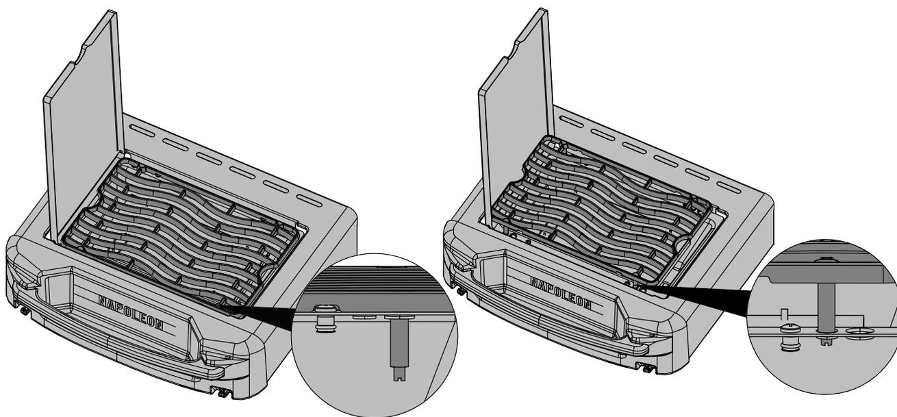
**Εγκατάσταση πλέγματος μαγειρέματος:** Το πλέγμα μαγειρέματος μπορεί να τοποθετηθεί σε δύο διαφορετικά ύψη. Το χαμηλότερο ύψος προορίζεται για χρήση με γλάστρες ή τηγάνια. Η υψηλότερη θέση πρέπει να χρησιμοποιείται κατά την κοπή του κρέατος. Βεβαιωθείτε ότι ο καυστήρας είναι απενεργοποιημένος και ότι το πλέγμα είναι δροσερό στην αφή πριν αλλάξετε μεταξύ των δύο υψών. Το πλέγμα πρέπει να βρίσκεται στο χαμηλότερο ύψος για να κλείσει το καπάκι.
